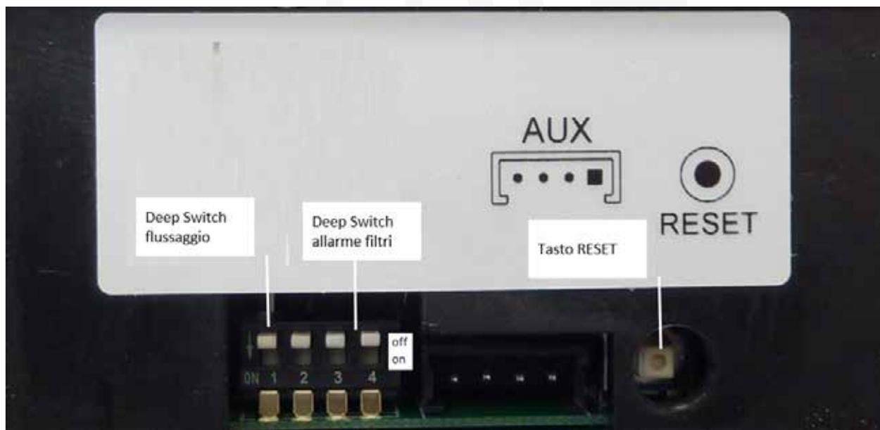
Allarme cambio filtro: al raggiungimento del tempo impostato tramite il DP3 e DP4 (vedi tabella) viene emesso un segnale acustico intermittente (buzzer, 0,5 sec. On- 0,5 sec. Off).
