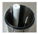
14. Inserire le cartucce all'interno del contenitore e fissare i connettori sulla estremità superiore;
